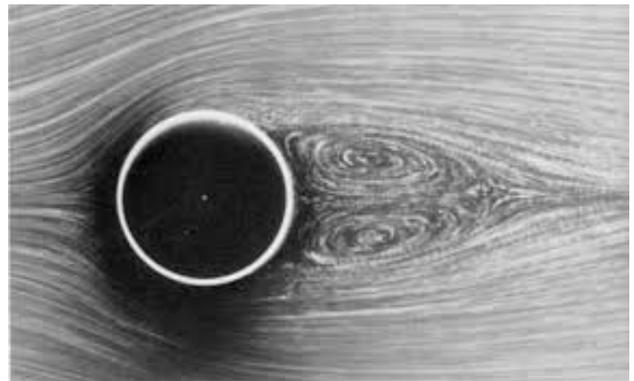
Écoulement présentant une zone turbulente
