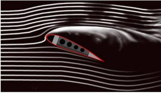
La photo ci-contre représente les lignes de courant d'un écoulement autour d'un profil type aile d'avion, visualisées par injection de fumée dans un écoulement d'air en soufflerie et photographie avec temps de pose long.
