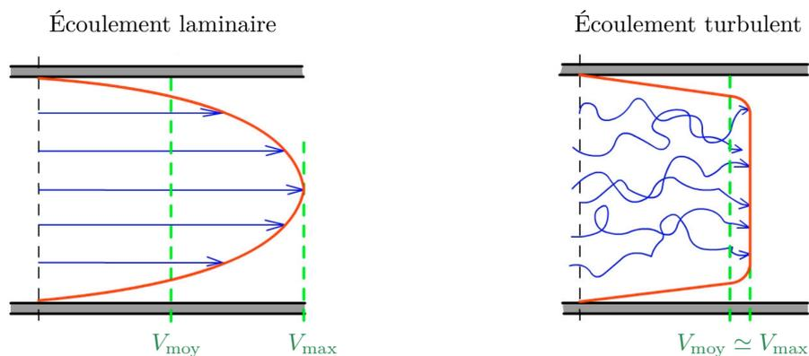
↪ contrairement à ce que l'on pourrait imaginer, ce sont les écoulements turbulents qui s'approchent le plus d'un écoulement parfait.
