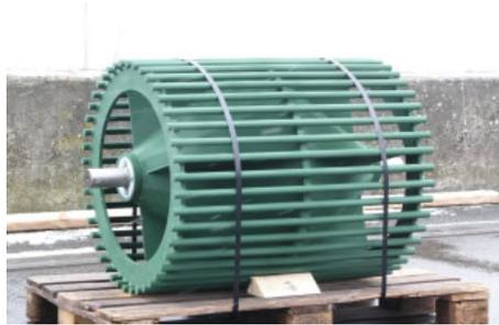
**Figure 7 – Rotor en cage d'écureuil.** Un rotor en cage d'écureuil est formé d'un ensemble de barres métalliques conductrices parallèles à l'arbre de la machine et reliant deux anneaux conducteurs. La photographie est celle du rotor d'une éolienne, générateur asynchrone.
