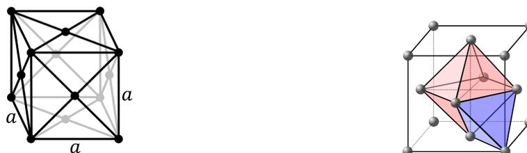
**Figure 11 – Structure CFC.** Gauche : Schéma de la maille. Droite : Sites interstitiels, octaédrique en rouge et tétraédrique en bleu. Figures extraites de Wikipédia. Version couleur sur le site de la classe.
