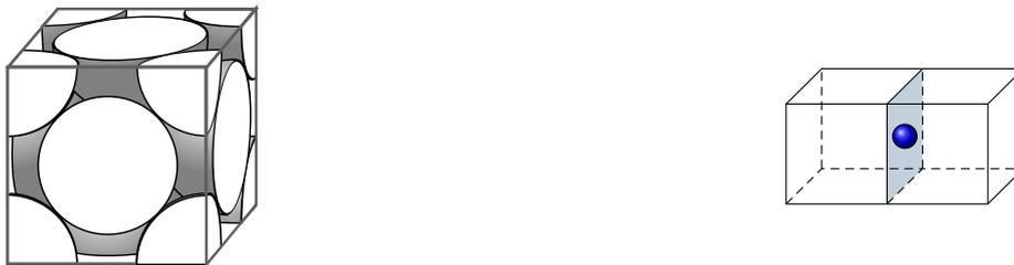
**Figure 8 – Atome au centre d'une face d'un cube, partagé entre plusieurs mailles.** Figure de gauche : point de vue de la maille, seule la moitié de l'atome s'y trouve. Figure de droite : point de vue de l'atome, il appartient à deux mailles différentes.
