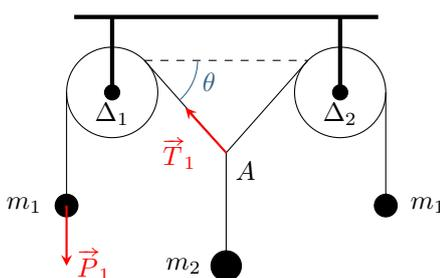
On s'intéresse au dispositif ci-contre, à l'équilibre et dans un plan. Les deux poulies sont identiques, de même rayon  $R$  et masse  $m_0$ , et les deux liaisons pivot avec le bâti sont modélisées par des liaisons parfaites : les frottements d'axe sont négligés. Les fils sont également tous supposés idéaux, c'est-à-dire qu'ils sont inextensibles et de masse négligeable. Enfin, on suppose que les fils ne glissent pas sur les poulies.
