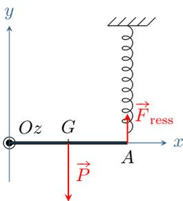
1 On étudie la barre, en mouvement par rapport au référentiel terrestre, considéré galiléen. Par hypothèse, dans la position d'équilibre, la barre est horizontale et le ressort vertical, ce qui permet d'orienter les forces. Comme les forces sont perpendiculaires à la barre, utiliser le bras de levier donne immédiatement les résultats. Elle est soumise à son poids, exercé en  $G$  au centre de la barre, de moment
