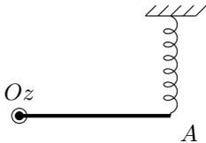
Considérons le système mécanique représenté ci-contre, constitué d'une barre de masse  $m$ , de longueur  $OA = 2a$ , libre de tourner sans frottement autour de l'axe  $Oz$ . Son moment d'inertie par rapport à cet axe vaut  $I_z = \frac{4}{3}ma^2$ . Elle est attachée en  $A$  à un ressort de longueur à vide  $\ell_0$  et de raideur  $k$ . L'autre extrémité du ressort est fixe.
