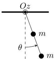
On considère un pendule formé d'une tige rigide de longueur  $L$  sur laquelle sont fixées deux masses  $m$  identiques à distance  $L/2$  et  $L$  du centre. On néglige le moment d'inertie de la tige.
