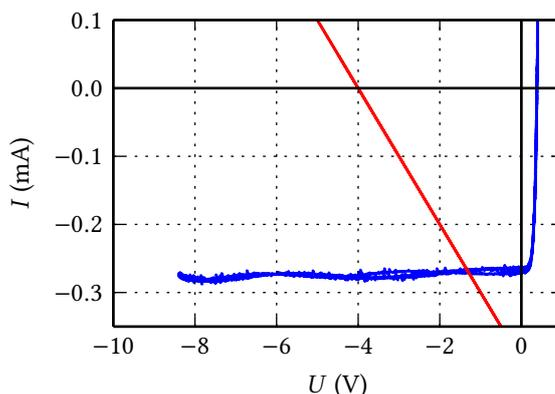
Figure 2 – Point de fonctionnement du montage à résistance de charge. La caractéristique de la photodiode, en bleu, est superposée à la contrainte imposée par le reste du montage, en rouge.
