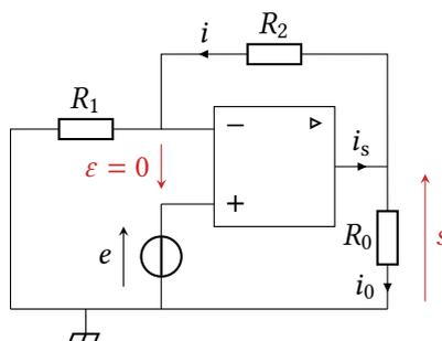
Figure 4 – Schéma du montage amplificateur à ALI.
