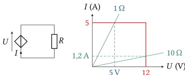
Figure 3 – Superposition des caractéristiques.
