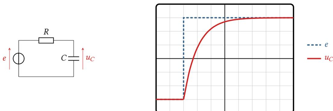
**Figure 1 – Étude expérimentale du circuit RC.** La tension imposée par le générateur varie instantanément de  $e = 0$  à  $e = E$  à l'instant  $t = 0$ , la courbe a été décalée sur l'écran pour bien la visualiser. Dessiner branchement oscillo
