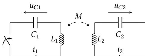
Dans le circuit ci-contre, seul le condensateur  $C_1$  est chargé sous la tension  $U_0$  à la date  $t = 0$  où l'on ferme l'interrupteur. On suppose  $C_1 = C_2 = C$  et  $L_1 = L_2 = L$ , et on pose
