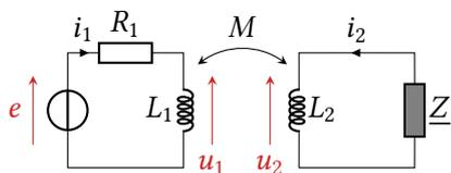
**I2.2** - Un transformateur alimenté par une source de tension sinusoïdale  $e$  débite dans une charge d'impédance complexe  $Z$ . Déterminer l'impédance d'entrée du transformateur, c'est-à-dire son impédance équivalente vue du primaire.
