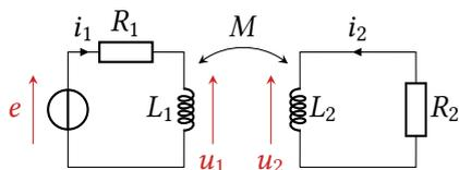
**I2.3** - Procéder au bilan de puissance du montage ci-contre. L'interpréter : montrer qu'il permet un transfert d'énergie sans contact, et identifier l'énergie magnétique.
