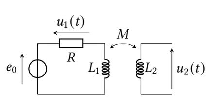
Le montage ci-contre permet de mesurer le coefficient d'inductance mutuelle entre deux bobines. Les deux bobines se font face comme sur la figure. La première bobine est montée en série avec une résistance  $R = 100 \Omega$  et un générateur de tension  $e_0$  harmonique de fréquence  $f = 2,0 \text{ kHz}$ . Les tensions  $u_1$  et  $u_2$  sont mesurées grâce à un oscilloscope supposé idéal, c'est-à-dire de résistance d'entrée infinie.
