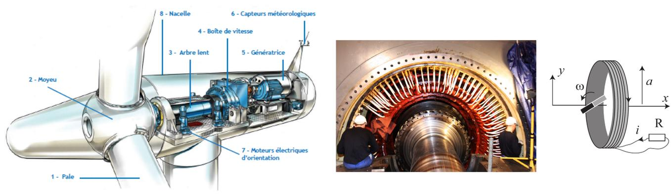
**Figure 1 – Éolienne.** La rotation des pales de l'éolienne permet de mettre en rotation le rotor (partie tournante) d'une génératrice située à l'intérieur de la nacelle. Des aimants permanents fixés sur le rotor créent alors un champ tournant, et par induction une tension dans les bobinages du stator (partie fixe) de la génératrice. La transmission par une boîte de vitesse permet d'augmenter la vitesse de rotation du rotor par rapport à celle des pales.
