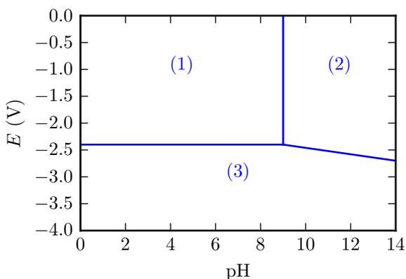
Le diagramme potentiel-pH du magnésium est représenté ci-contre, pour les espèces  $\text{Mg}_{(s)}$ ,  $\text{Mg}_{(aq)}^{2+}$  et  $\text{Mg}(\text{OH})_{2(s)}$ .
