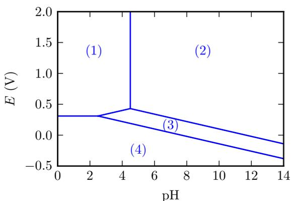
Le diagramme potentiel-pH du cuivre est représenté ci-contre, pour les espèces  $\text{Cu}$ ,  $\text{Cu}^{2+}$ ,  $\text{Cu}(\text{OH})_2$ ,  $\text{Cu}^+$  et  $\text{Cu}_2\text{O}$ . L'oxyde  $\text{Cu}_2\text{O}$  est considéré plutôt que l'hydroxyde car celui-ci se déshydrate spontanément.
