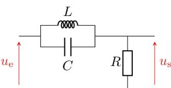
La tension  $u_e$  est issue d'un appareil de mesure, mais se trouve parasitée par un bruit à 50 Hz due à la tension d'alimentation de l'appareil. On souhaite l'éliminer à l'aide du filtre schématisé ci-contre.
