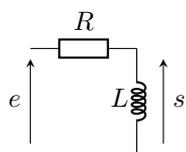
On considère le circuit ci-contre avec  $R = 1,0\text{ k}\Omega$  et  $L = 10\text{ mH}$ .
