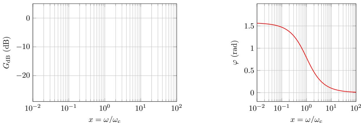
Figure 1 – Diagramme de Bode du filtre RL.
