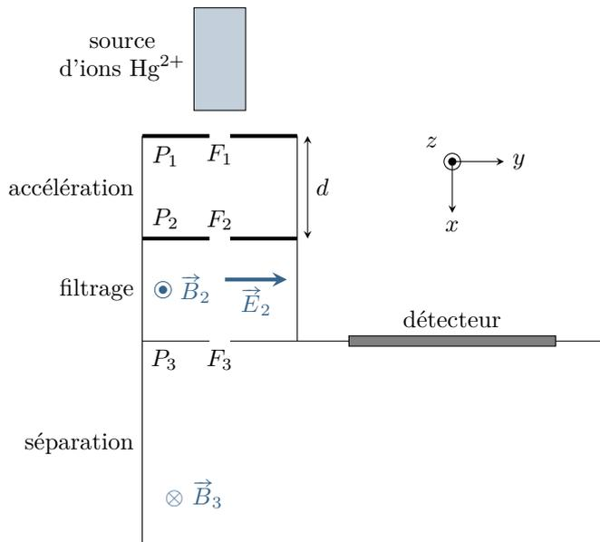
Un spectromètre de masse est un appareil qui permet de mesurer la masse ou la charge d'un ion (plus précisément le rapport entre les deux). De nombreuses technologies de spectromètre de masse existent : nous étudions ici le principe d'un spectromètre dit « à secteur magnétique ».
