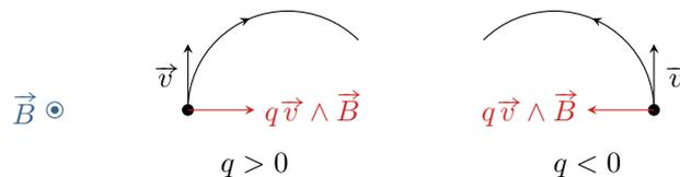
**Figure 1 – Sens de la force de Lorentz.** Connaissant la vitesse  $\vec{v}$  et le signe de  $q$ , on construit la force de Lorentz, puis on en déduit le sens dans lequel est déviée la particule soumise à cette force uniquement. Ces schémas permettent de se convaincre et/ou de retrouver que la force de Lorentz est toujours portée par le vecteur unitaire normal  $\vec{n}$  de la base de Frénet.
