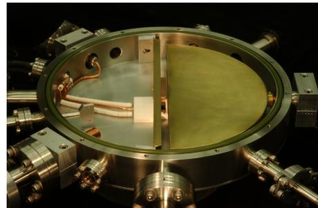
**Figure 2 – Étude d'un cyclotron.** Schéma de principe et photo du cyclotron de l'université de Rutgers, qui mesure une trentaine de centimètres de diamètre.
