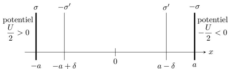
Figure 2 – Supercondensateur avec double couche parfaitement surfacique.
