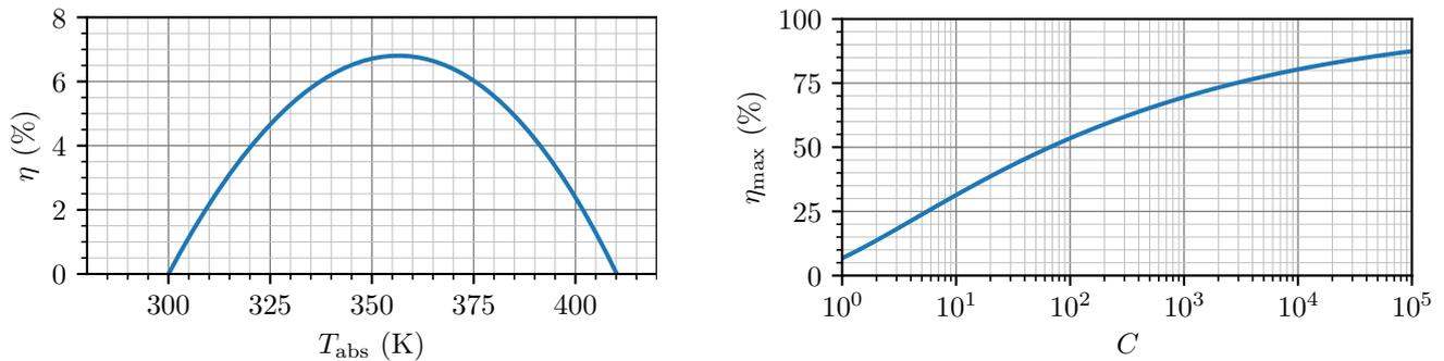
**Figure 2 – Rendement d'une machine de Müzer.** Gauche : rendement maximal d'une machine de Müzer en fonction de la température de l'absorbeur. Droite : optimum de rendement d'une machine de Müzer en fonction du facteur de concentration  $C$ .
