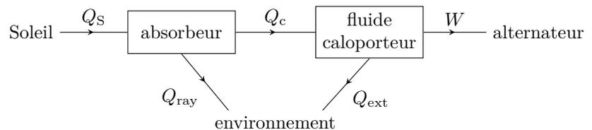
**Figure 1 – Centrale solaire à concentration.** Gauche : La lumière solaire est déviée par les miroirs vers un absorbeur se trouvant au sommet de la tour centrale. Droite : Schéma de principe des échanges énergétiques, le fluide caloporteur étant généralement de l'eau.
