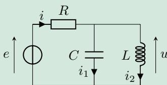
En appliquant la loi des nœuds et en utilisant les admittances complexes, exprimer l'amplitude complexe  $\underline{U}$ .
