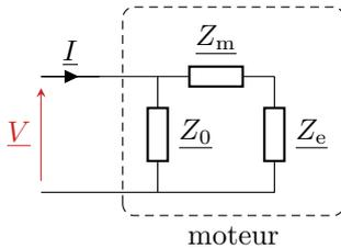
Un moteur à ultrasons est alimenté par une tension sinusoïdale d’amplitude complexe  $\underline{V}$ , on note  $\underline{I}$  l’amplitude complexe du courant passant dans le moteur. Pour que le rendement du moteur soit optimal, il doit être alimenté à une fréquence égale à sa fréquence de résonance en courant.
