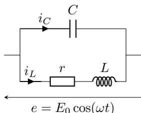
Considérons un dipôle constitué d'une bobine (inductance  $L$  et résistance interne  $r$ ) montée en dérivation avec un condensateur (capacité  $C$ ). Il est alimenté par la tension sinusoïdale  $e(t)$  de pulsation  $\omega$  variable.
