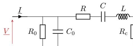
Figure 3 – Schéma complet du modèle électrique de moteur.
