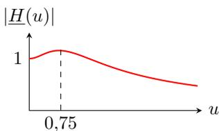
Pour un VTT se déplaçant à la vitesse (horizontale!)  $V$  sur un chemin fait de cailloux de taille typique  $\ell$ , le spectre d'excitation est maximal autour de  $\omega = 2\pi V/\ell$ . La figure ci-contre représente l'allure de  $|\underline{H}(u)|$  pour  $\xi = 1$ .
