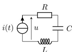
Considérons un circuit RLC série alimenté par un générateur idéal de courant imposant  $i(t) = I_m \cos(\omega t)$ .
