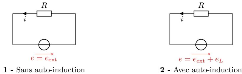
Figure 4 – Schémas électriques équivalents.
