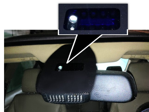
Figure 1 – Principe de fonctionnement d'un détecteur de pluie.
