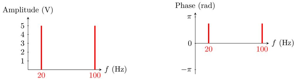
Figure 4 – Spectre du signal produit.
